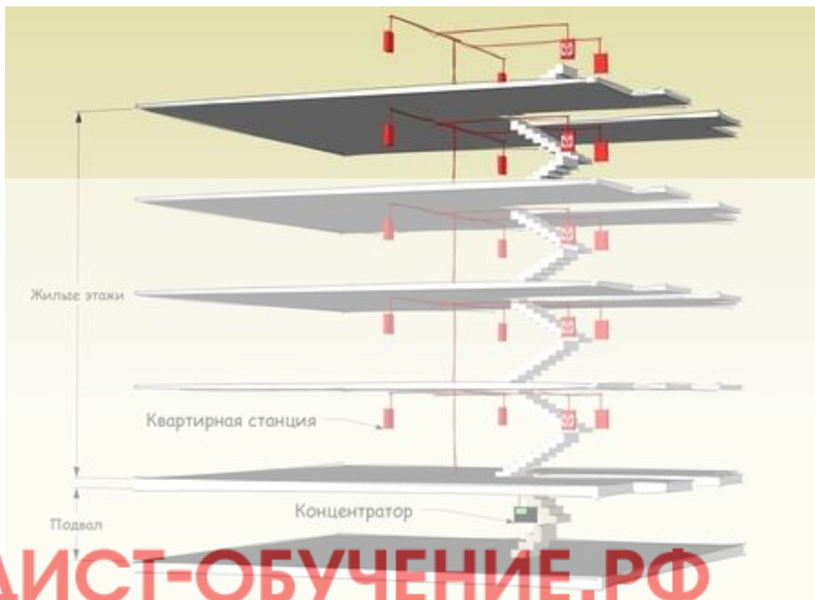
Рисунок 5 – Структура сбора данных по сети стандарта M-Bus
